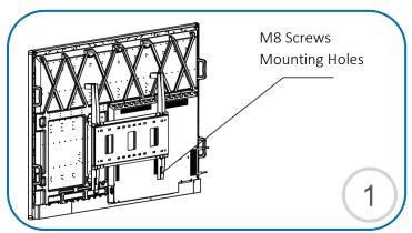
Vier M8-Schrauben, die der Größe der VESA-Löcher entsprechen, werden verwendet, um die beiden vertikalen Stangenaufhängungen an den VESA-Montagelöchern auf der Rückseite des Touchscreens zu befestigen.
