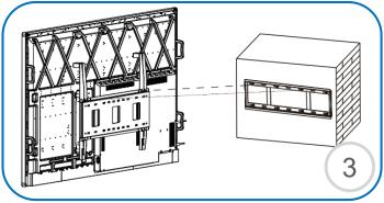
Sobald die Wandhalterung installiert und ordnungsgemäß befestigt ist, können Sie den Touchscreen aufhängen. Sie können den Screen noch seitlich ausrichten, nachdem er eingehängt ist.
